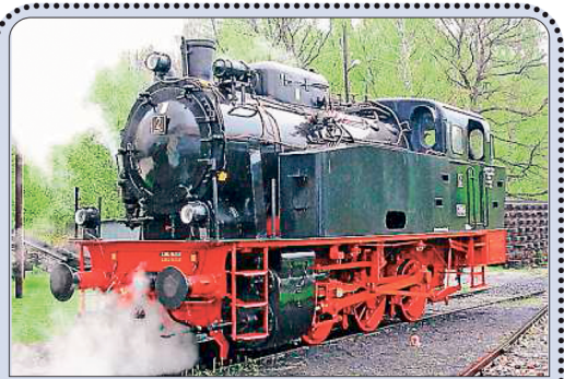
Eine der Jan Harpstedt-Loks. Der Dampfdruck in ihrem Kessel treibt die Räder an.
